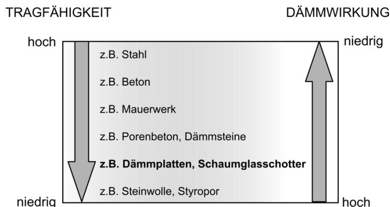
**Bild 1** Entgegengesetzte Anforderungen an Tragfähigkeit und Dämmwirkung
