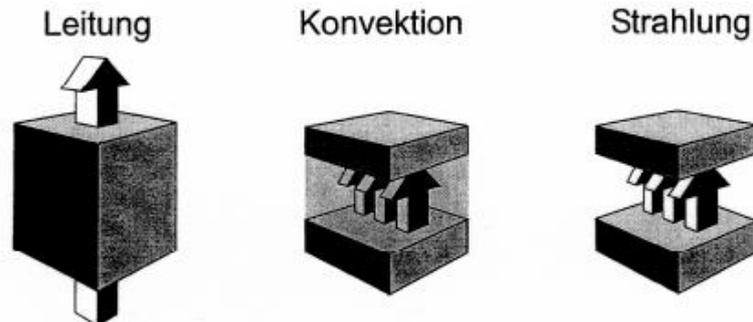
**Bild 2** Die drei Mechanismen des Wärmetransportes (Sedlbauer & Krus 2009)
